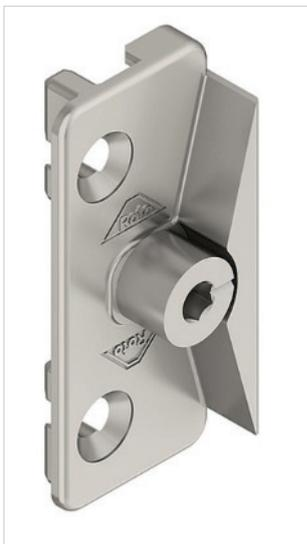
Durch das Drehen der exzentrischen Stellschraube am Rahmenteil der Niveauschaltperre kann der Flügelleinlauf um bis zu 0,8 mm angehoben bzw. abgesenkt werden.
