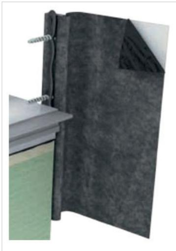
2. Flansch am seitlichen Elementrahmenrücken bündig Unterbauprofil positionieren
