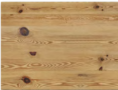
Altholz Fichte Typ 3A (roh, unbehandelt 2 ) Unterdach-Bretter, leicht gebürstet, leicht gedämpft und in Handarbeit mit Echtholz ausgefleckt. Struktur Quer oder Längs.
