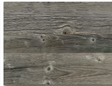
Altholz Fichte Typ 5C (roh, unbehandelt 2 ) Sonnenvorbrannt, leicht gebürstet und in Handarbeit mit Echtholz ausgefleckt. Struktur Quer oder Längs.
