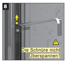
Beide Schrauben wieder anziehen. Den Vorgang mit dem oberen Spanner wiederholen. Darauf achten, dass die Schnüre nicht überkreuzt sind und dass beide Schrauben abwechselnd mit Gefühl (nicht zu fest) angezogen werden! Der Schnurspanner sowie die Feder dürfen **nicht** nach außen stehen - das könnte die Montage und die Funktion des Magneten negativ beeinflussen.
