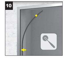
Die Magnetleiste auf der Schließseite in die vertikale Führungsschiene drücken.
