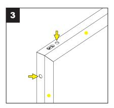
Adapterprofilrahmen direkt an den Türrahmen schrauben.
