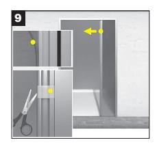
Einen Funktionstest durchführen und das Gewebe im geschlossenen Zustand auf Beschädigungen und Kleberückstände \* überprüfen.
