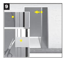
Einen Funktionstest durchführen und das Gewebe im geschlossenen Zustand auf Beschädigungen und Kleberückstände \* überprüfen.
