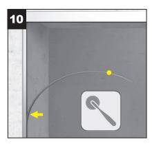
Überprüfen Sie die richtige Lage (Polung) der Magnetleiste, indem Sie eine Haftprobe bei der Griffleiste vornehmen. Die Magnetleiste dann auf der Schließseite in die vertikale Führungsschiene drücken.
