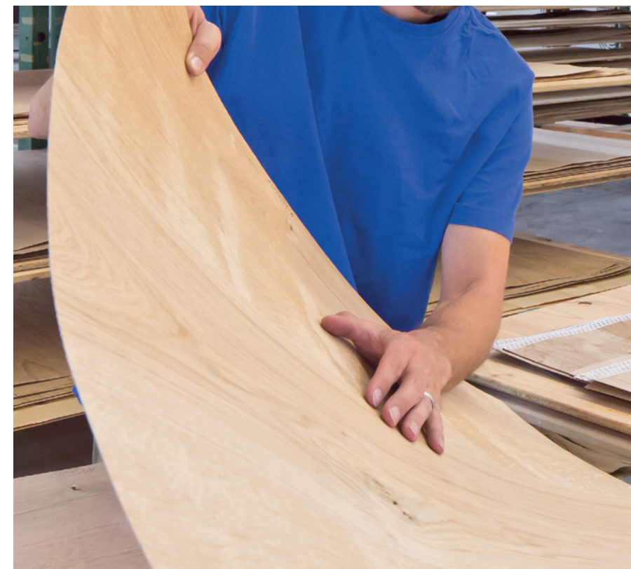
Jedes einzelne Furnierblatt erfährt vor der Verleimung eine strenge Endkontrolle.
