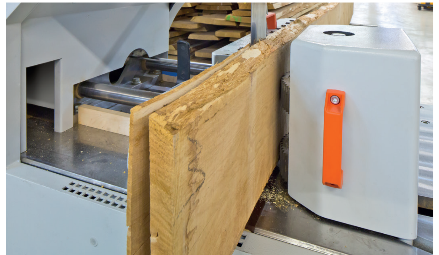
Hier werden die 4mm starken Decklamellen geschnitten.
